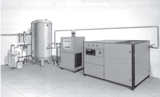
Bild 8.8 : Kompressorstation mit Schraubenkompressor, Kälte-Drucklufttrockner, Druckluftbehälter und Filtersystem
