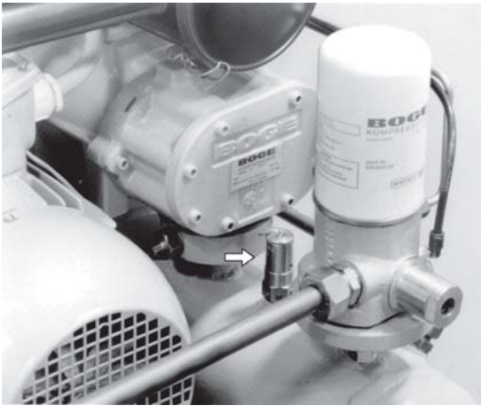
Bild 9.5 : Sicherheitsventil am kombinierten Druckluft-Öl- Behälters eines öleinspritzgekühlten Schraubenkompressors
